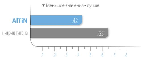
Измерения производились между стальным шаром и образцом с покрытой поверхностью
